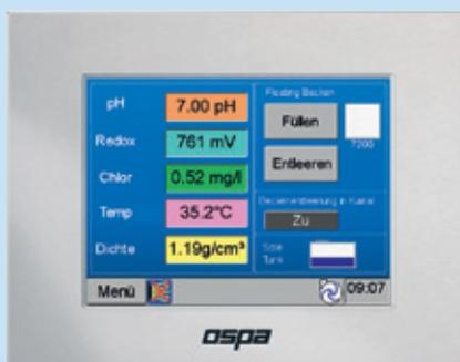
Der BlueControl®-Pilot mit Touchscreen ist die Bedieneinheit der Floatinganlage.
